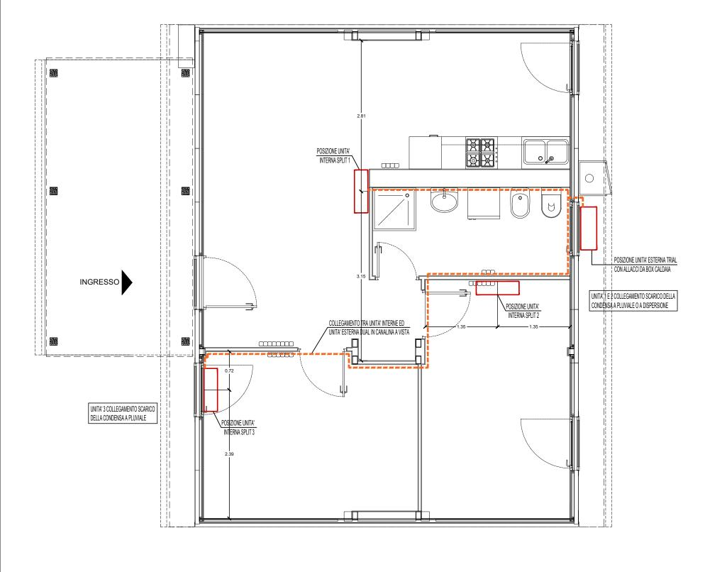
SEZIONE scala 1:50 POSIZIONE SPLIT 3 POSIZIONE SPLIT 2 POSIZIONE UNITA' ESTERNA TRIAL
